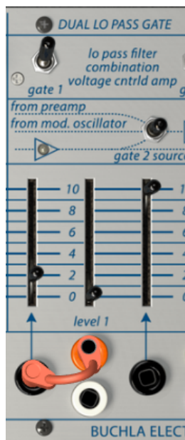
Le Dual Low Pass Gate en tant que filtre
