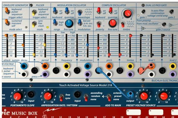
プリセットボルテージソースの出力をコンプレックスオシレーターに加える
