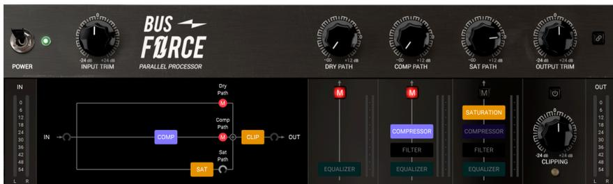
Bus FORCEのサブミックス部分とルーティングディスプレイ。各バスで個別のインプットを選択している状態で、ミュートボタンの上には各バスのボリュームノブがあります。SATバスではサチュレーションモジュールだけがオンになっており、COMPバスではコンプレッサーだけがオンになっています。
