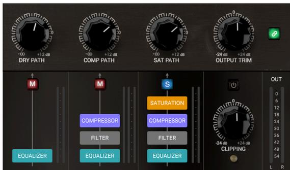
Satパスがソロになり、全モジュールがオンの状態。各モジュールのネームボックスが全点灯しています。
