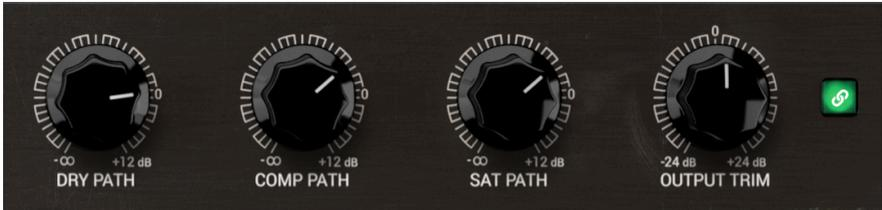
Bus FORCEの各パスのボリュームノブと、OUTPUT TRIMノブ。その右のリンクスイッチがオンになっています。これは、INPUT TRIMノブの変化に応じてOUTPUT TRIMノブが自動補正をする状態です。
