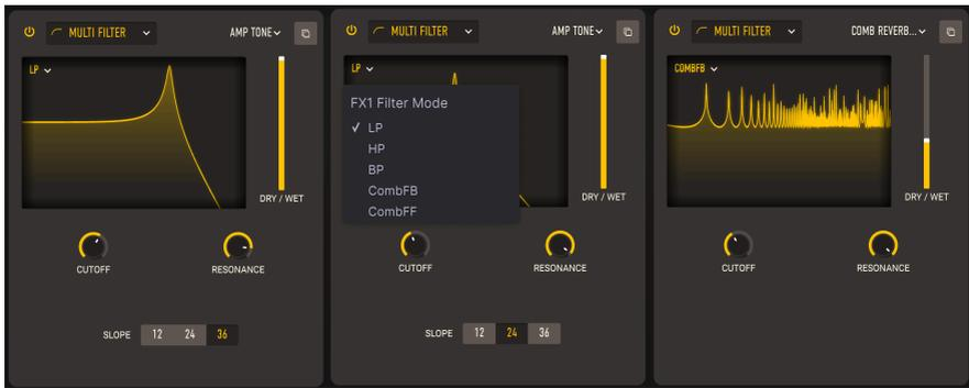
Manchmal macht es Sinn, ein zusätzliches Filter zur Hand zu haben, um den Sound zu optimieren, bevor er an den Ausgang gelangt. Der **Multi Filter**-Effekt bietet Ihnen fünf Filter zur Auswahl!
