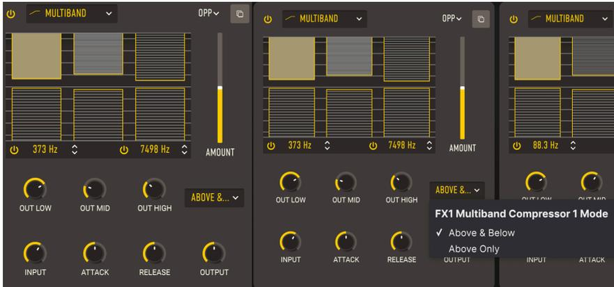
Ein Multiband-Kompressor funktioniert wie eine Serie normaler Kompressoren, aber jeder arbeitet in einem separaten Frequenzbereich (dem *Band*). Diese Kompressoren wurden zuerst als Hardware verwendet, um es Mastering-Ingenieuren zu ermöglichen, das absolute Maximum aus Aufnahmen herauszuholen. Aber sie lassen sich auch für subtile Soundformung, Sounddesign, Spezialeffekte und vieles mehr einsetzen.
