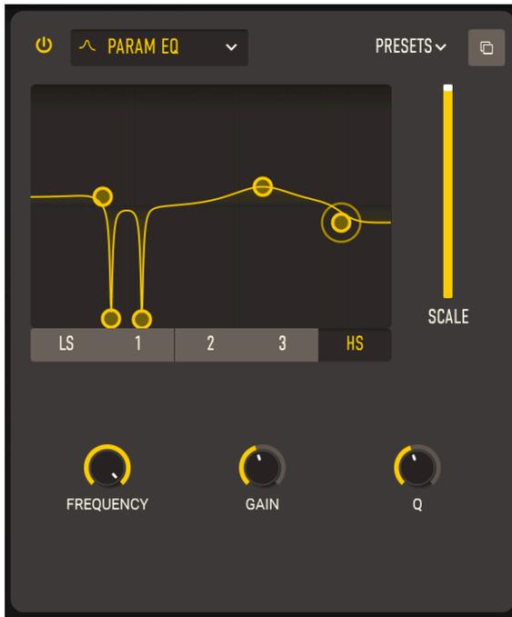
Mit einem **parametrischen Equalizer** können Sie den Klang sehr präzise formen, im Gegensatz zu den sehr breiten Frequenzbereichen, die grafische Equalizer oder die Klangregler bei einer Gitarre oder bei einem Verstärker bieten. Dieser EQ kann verwendet werden, um bestimmte Frequenzen sanft oder chirurgisch anzuheben bzw. abzusenken, um so den Gesamtklang eines Sounds zu verändern oder problematische Frequenzen zu entfernen.
