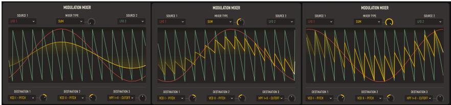
**Sum:** Source 2 wird zu Source 1 hinzugefügt. Im nachfolgenden Beispiel wird LFO 1 (eine langsame Sinuswelle) durch LFO 2 (eine schnellere Sägezahnwelle) moduliert, wobei der Amount einmal auf 0, auf 0.5 und auf 1.0 eingestellt ist. Vergleichen Sie das mit **Diff**; hier besitzt die resultierende Wellenform die gleiche Polarität wie Source 2.
