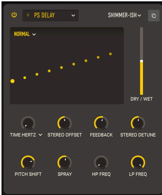
Das **Pitch Shift Delay** ist ein klassischer Effekt aus den Anfangsjahren der digitalen Audiotbearbeitung, der durch den Eventide Harmonizer populär wurde. Es funktioniert wie ein herkömmliches Delay, aber zusätzlich zur Rückkopplung für die Erzeugung der Echos erhalten die verzögerten Audiosignale eine Tonhöhenverschiebung, entweder nach oben oder nach unten.
