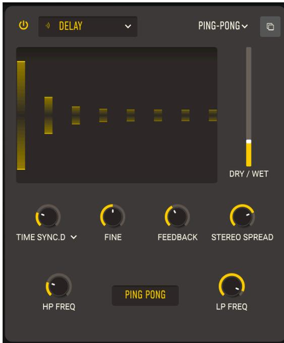
**DELAY** ist ein Oberbegriff für jeden Effekt, der ein Eingangssignal kopiert und kurze Zeit später wiederholt. Der CS-80 V bietet mehrere Delay-Effektarten. Der erste ist ein sauber klingendes digitales Delay für alle Arten von Anwendungen.
