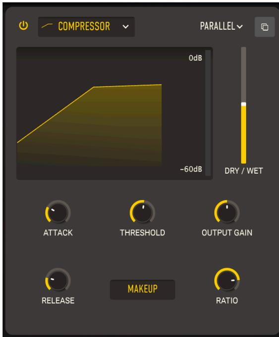
Ein **Kompressor** wird verwendet, um den Dynamikbereich eines Sounds anzupassen: Er reduziert den Unterschied zwischen den leisesten und lautesten Signalpegeln eines Sounds.
