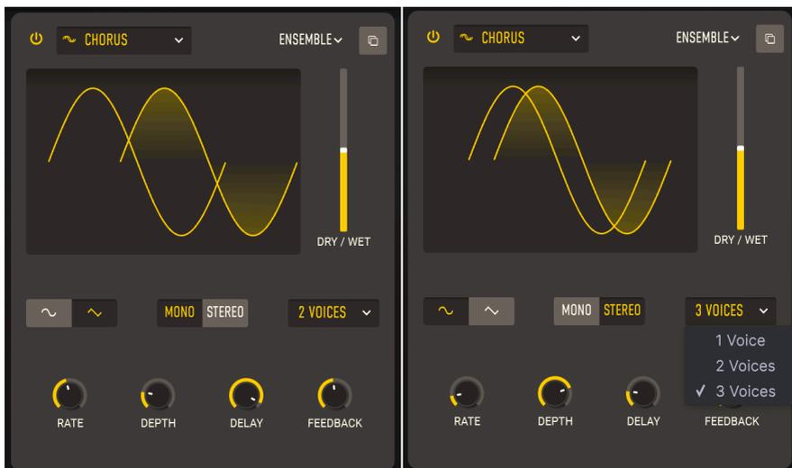
Der **Chorus** ist ein Effekt, der erstmals in den 1970er Jahren von Roland für den Jazz Chorus-Verstärker und das CE-1-Pedal entwickelt wurde. In einem Chorus wird das trockene Signal mit einer oder mehreren leicht verzögerten Kopien von sich selbst (genannt *Voices*) zusammengemischt, deren Verzögerungsintensität leicht von einem LFO variiert wird, um ein Gefühl von mehr Breite zu erzeugen.
