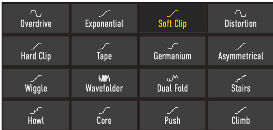
Einige dieser Algorithmen stammen von bekannten analogen Verzerrungsarten - diese umfassen allmählich zunehmende Verstärkungsgrade (**Overdrive**, **Exponential**, **Soft Clip**, **Distortion**, **Hard Clip**), **Tape**-Sättigung und **Germanium**-Transistor-Vorverstärkung.
