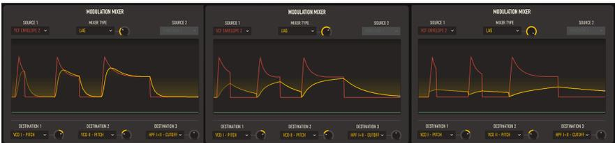
**Lag:** Ein *Lag-Prozessor* nimmt abrupte Spannungsänderungen und "verschmiert" diese im Laufe der Zeit. Lag wird hier auf Source 1 angewendet, Source 2 wird nicht verwendet.
